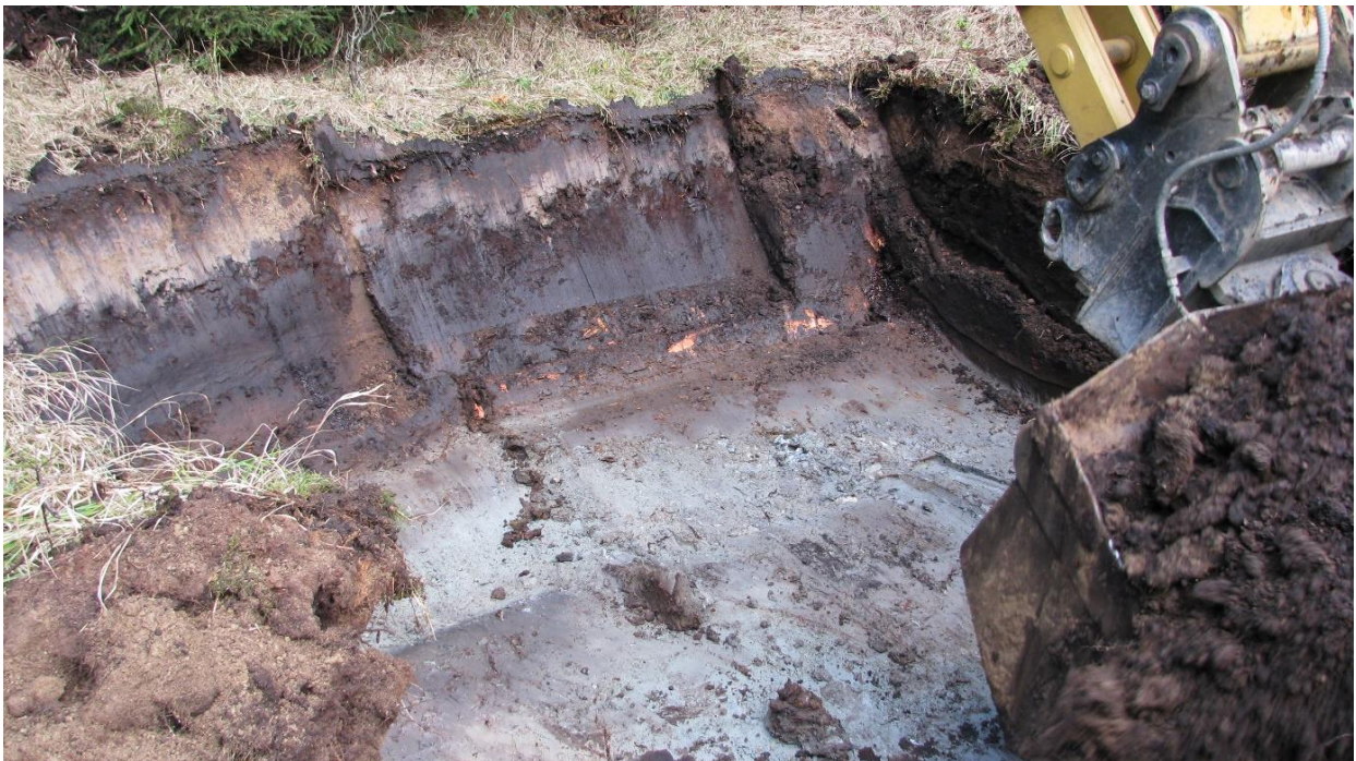
Abb.: Das „Auerhahnmoor“ im mittleren Erzgebirge bei Reitzenhain, in einer Höhe von 770 m ü. NN, zeigt im Randbereich eine flache Torfschicht von 0,5 Meter Mächtigkeit aus jüngerem Moostorf. Gut zu erkennen ist auch die blaugraue Gneiszersatzschicht, die im vorliegenden Fall als Stauhorizont die Moorentwicklung im „Auerhahnmoor“ ermöglichte. Foto: Jens Nixdorf
